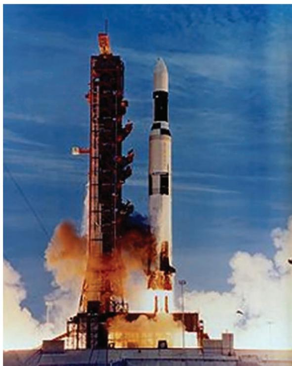
**Fig. 52 – Un lancio del Saturno V protagonista del programma Apollo che ha portato l'uomo sulla Luna. Il razzo, a tre stadi, era alto 110 m, con diametro 10 m, e il primo stadio era propulso da 5 motori con una spinta complessiva di 34.000 kN (3470 ton).**
